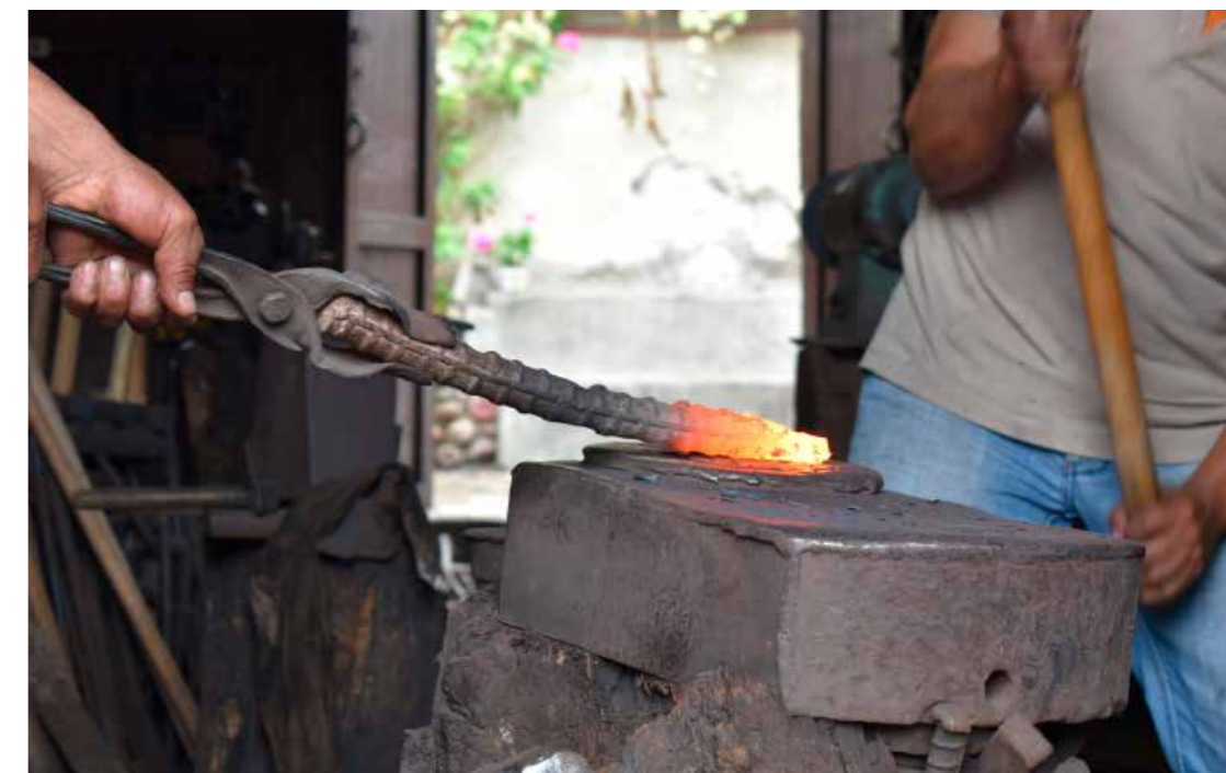
Conformación del objeto en el yunque.
