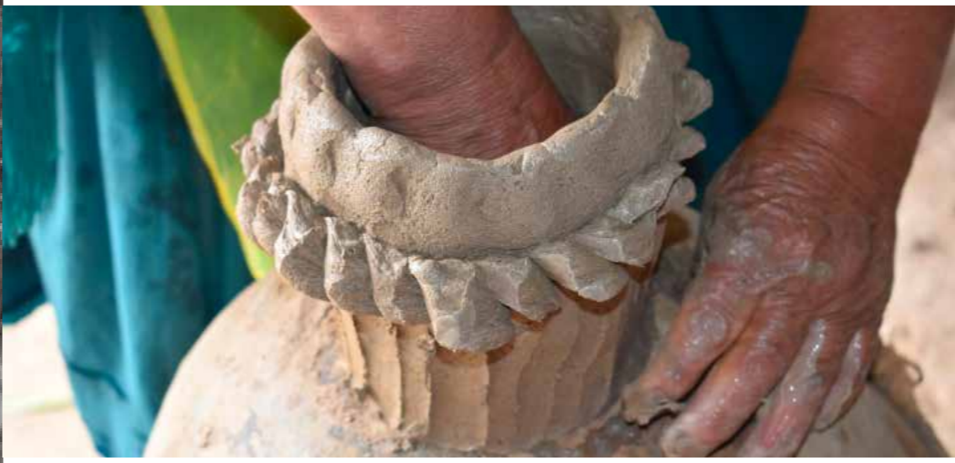
3. Para engrosar la pared se colocan refuerzos de material alrededor del objeto.
