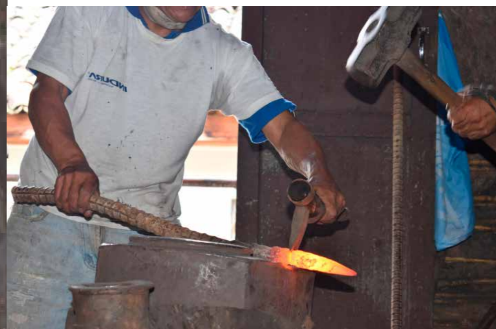
3. Cortado del hierro para obtener el producto deseado.
